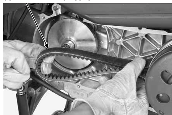
CONJUNTO DA FACE MOTORA MÓVEL CORREIA DE TRANSMISSÃO
