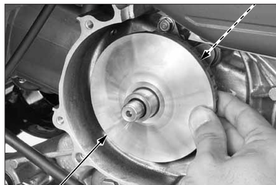
CONJUNTO DA FACE MOTORA MÓVEL CORREIA DE TRANSMISSÃO
